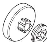
Следует регулярно проверять степень износа звездочки привода. Заменять при сильном износе. При замене цепи следует одновременно заменять и звездочку привода.
