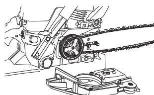
Для этого поверните винт механизма регулировки цепи по часовой стрелке. Цепь следует натягивать до тех пор, пока она не будет плотно прилегать к нижней стороне пильного полотна. См. указания в разделе Натяжение цепи пилы.
