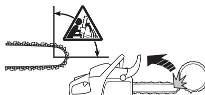
Отдача всегда происходит в плоскости резания пилы. Обычно при отдаче моторная пила отбрасывает назад и вверх в направлении рабочего. Тем не менее моторная пила в момент отдачи может двигаться в различных направлениях в зависимости от метода резки, который применялся в момент касания зоны отдачи полотна и объекта.
