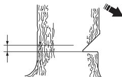
Вставьте зубчатый упор (если установлен) сзади надреза. Работайте на полном газу и вводите пильное полотно в ствол дерева постепенно, плавным движением. Следите за тем, чтобы дерево не начало перемещаться в направлении, противоположном предполагаемому направлению падения. Как только пропил станет достаточно глубоким, загоните в него клин или вагу.
