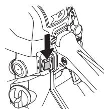
**ПОМНИТЕ!** Выключатель Запуск/Остановка автоматически переходит рабочее положение. В целях избежания непроизвольного запуска, головка свечи должна быть всегда снята со свечи когда вы оставляете машину без присмотра.
