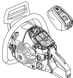
Для более тщательной чистки фильтр следует помыть в воде с мылом.
