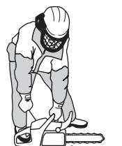
Твердо возмите моторную пилу, обхватив ручки всей ладонью.
