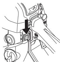
**ПОМНИТЕ!** Выключатель Запуск/Остановка автоматически переходит рабочее положение. В целях избежания непроизвольного запуска, головка свечи должна быть всегда снята со свечи при сборке, проверке и/или обслуживании.
