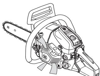
**ВАЖНО!** Для осуществления метода центробежной очистки нужно постоянно выполнять техническое обслуживание и уход за системой. Необходимо чистить
