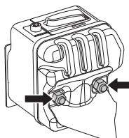
В некоторых глушителях предусмотрен специальный искрогаситель. Если ваша машина оборудована таким глушителем, сетку фильтра следует чистить раз в неделю. Наилучшие пользоватьсяся стальной щеткой. Забитая решетка приводит к работе с горячим двигателем, что дает серьезные повреждения двигателя.
