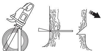
Закончить основной пропил нужно параллельно линии направляющего пропила так, чтобы расстояние между ними составляло около 1/10 диаметра ствола. Нераспиленный участок ствола называется полоса разлома (недопил). Полоса разлома действует как петельный щарнир, задающий направление падения дерева.
