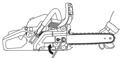
При установке новой цепи следует часто проверять ее натяжение, пока цепь не приработается. Регулярно проверяйте натяжение цепи. Регулярно проверяйте натяжение цепи. Правильно натянутая цепь обеспечивает высокое качество пиления и дольше служит.
